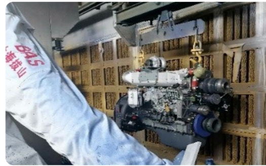
开展干式喷漆房改造项目，提升喷漆废气的吸附去除效率，降低废气排放浓度
